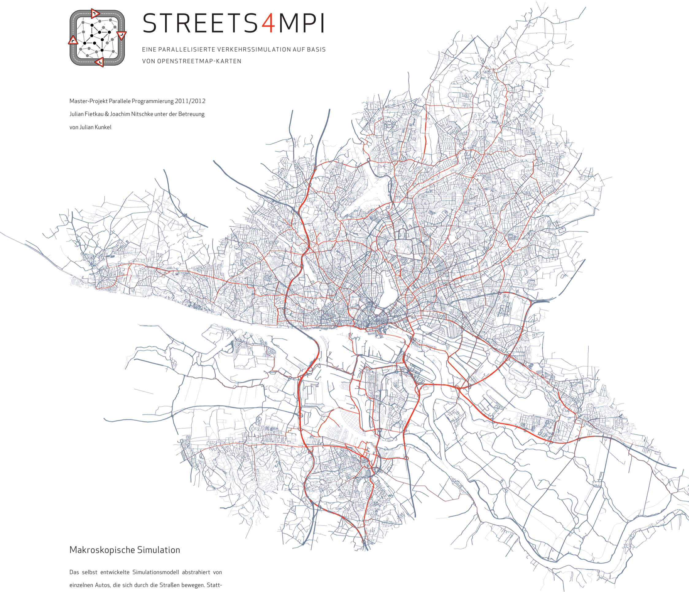
Grafik aus den Daten einer Simulation auf Basis des Hamburger Straßennetzes. Straßen mit erhöhter Verkehrslast sind rot gefärbt.
